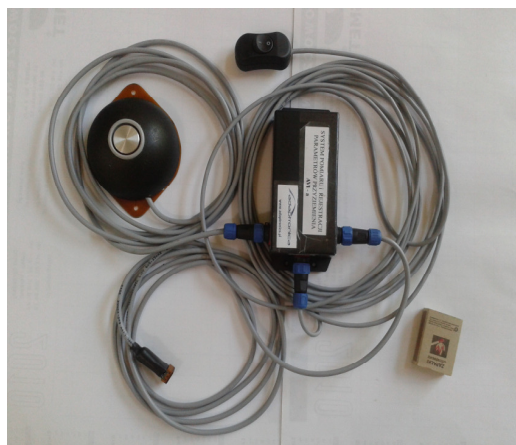
Rys. 2 Widok prototypu systemu AVI-a z głowicą ultradźwiękową, przetwornikiem drgań oraz włącznikiem zasilania
